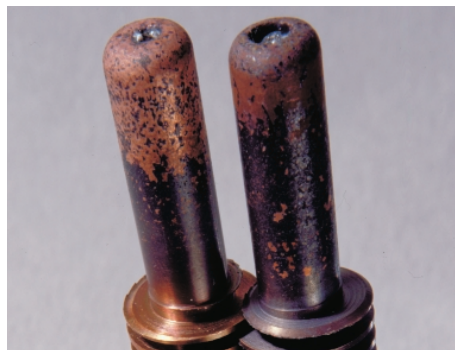
Elektroda po normalnym użytkowaniu, elektroda po nadmiernym użytkowaniu
